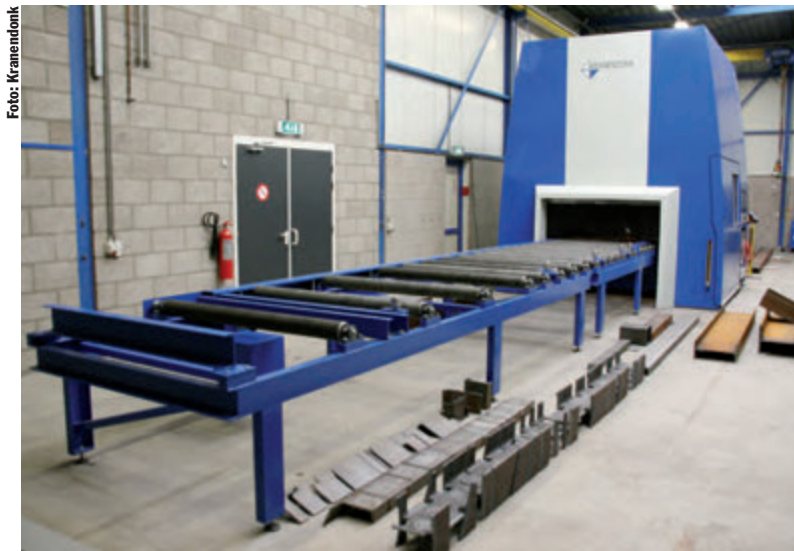
Das Schneidsystem CCS bietet Kranendonk in drei Varianten an
