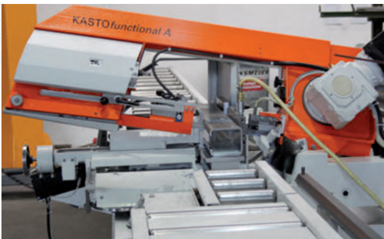
Kompakt gebaut, robust und mit großem Schnittbereich: Bandsäge KASTOfunctional A Flexibilität
