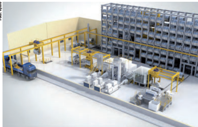
Vollautomatischer Coiltransport im Aluminiumwalzwerk von Hydro
