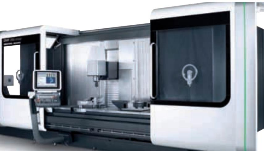
**Beeindruckende Leistungsdaten: Fahrständer-Bearbeitungszentrum DMF 260 linear**
