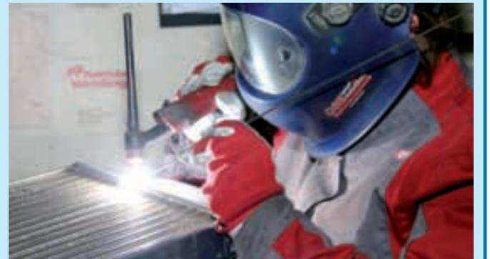
Schweißarbeiten am Aluminiumkühler für die Automobilindustrie
