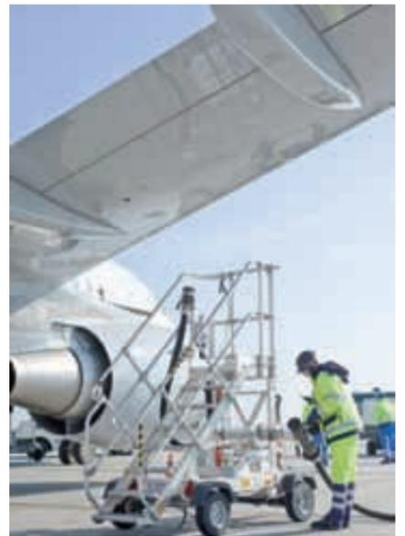
Fixiert: der Betankungsschlauch – mithilfe von Arbeitsplattform und Geländer
