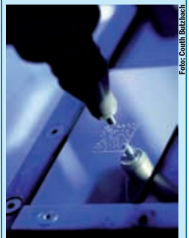
Data-Matrix-Code vertieft markiert
