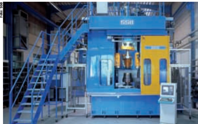
Einzeln programmierbare Rollenachsen: 3-Rollen-Drückzentrum 3VDZ
