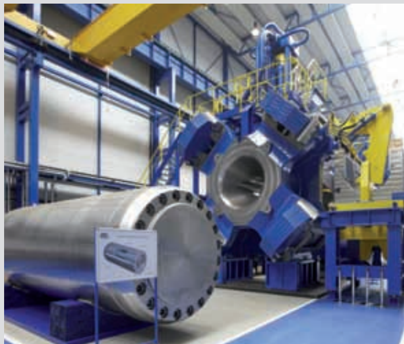
150 MN-Pressen mit 70 Tonnen schweren Rezipienten und Bolzenladeeinrichtung
