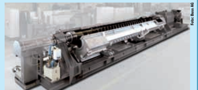
Großauftrag für die Buss AG: Knetlinie zum Herstellen von Anodenmassen
