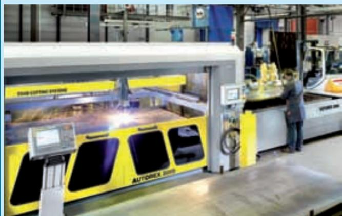
Komplettpaket zum automatisierten Plasmaschneiden: die AUTOREX
