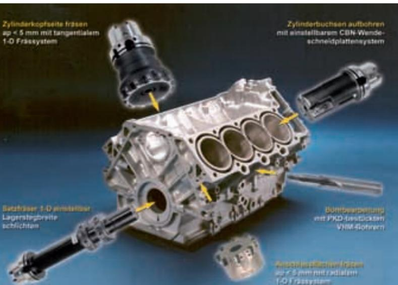
Anschaulich: die Komplettbearbeitung eines Aluminium-Motorblockes
