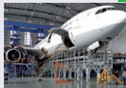
Dockanlagen, Undercarriage-Bühnen, motorisch verstellbare Arbeitsbühnen, Rollgerüste oder Leitern: Wir haben die passende Lösung für die effiziente Wartung von Flugzeugen und Hubschraubern – auch in individueller Fertigung.
