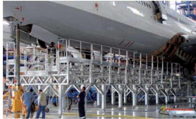
Acht fest verbundene Einzelsegmente: die Arbeitsfläche vom Bug bis zum Fahrwerk
