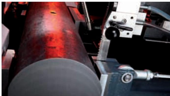
Sägen von Rundmaterial: mit automatischem Materialvorschub und hydraulischem Spannstock
