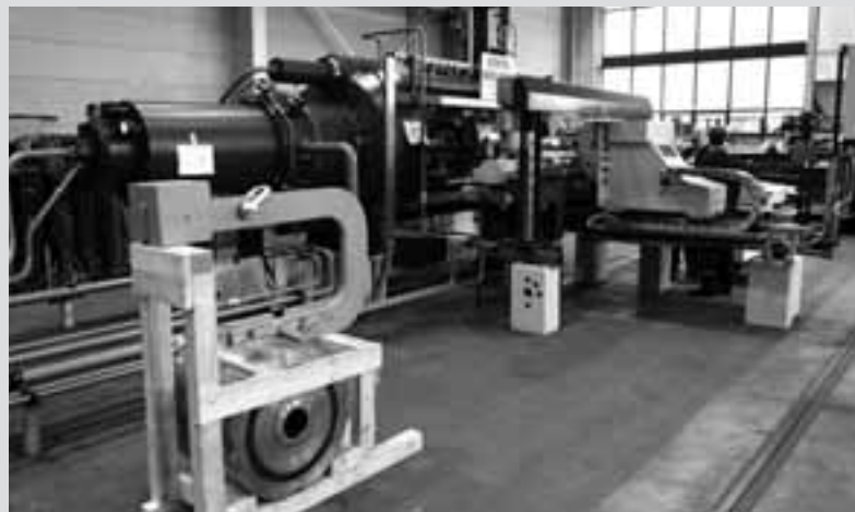
Begeht: die Kompaktpresse mit 10 MN-Presskraft im Herstellerwerk Aachen
