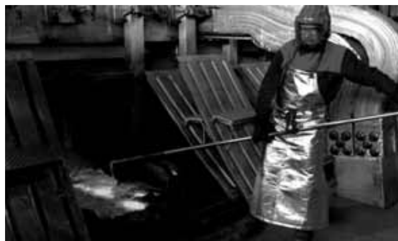
Primäraluminium wird im Elektrolyseverfahren hergestellt
