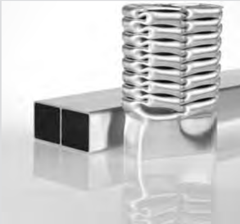
Crashprofil aus dem Werkstoff Duktal, im Ausgangszustand...
