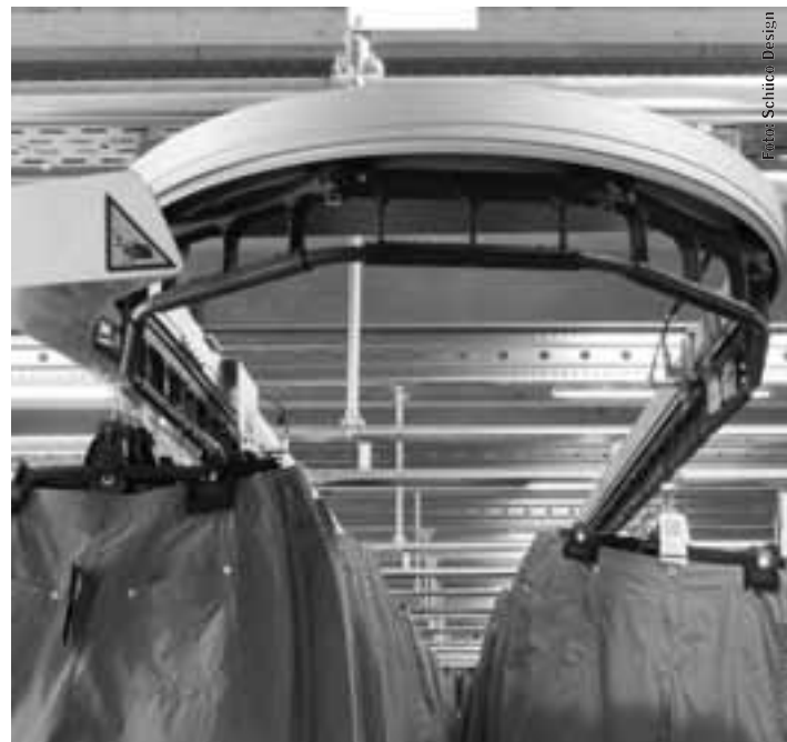
CS OC-Sortierbereich: Rundbogen mit Zugstange
