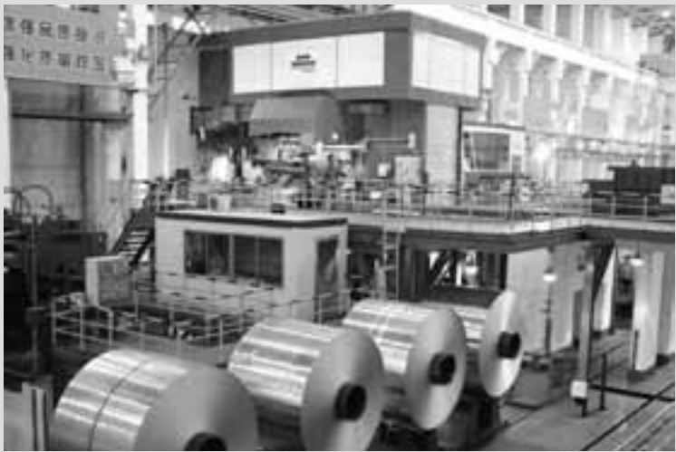
Aluminium-Kaltwalzwerk: errichtet von SMS bei der chinesischen Nanshan Aluminium Company
