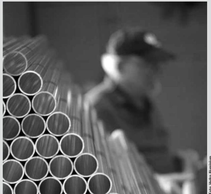
Rohre aus Aluminium eignen sich bestens für den Bau von Wärmetauschern
