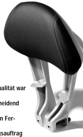
zen und Kostenanforderungen wurde für die Herstellung der Rückenlehne Kokillenguss gewählt. Wegen der hohen Stückzahl und der vorgegebenen Abmessungsgenauigkeit sowie der Oberflächenverarbeitung wurde für die Herstellung des Trägers Druckguss gewählt. Beide Aluminiumteile haben alle betriebsinternen Belastungstests und Tests mit einer neuen Röntgenmaschine erfolgreich bestanden. In Zusammenarbeit mit mehreren Geschäftspartnern im Bereich der Oberflächenverarbeitung und Pul-
