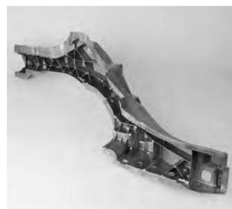
Es handelt sich um ein multifunktionales Großgussbauteil, das Dank der Herstellung in Aluminium-Druckguss ca. 20 Bauteile gegenüber einem Längsträger in Stahlbauweise ersetzt. Aber auch gegenüber der bisher eingesetzten Aluminium-Bauweise unter Einsatz von Gussbauteilen ergibt sich noch eine Reduzierung von sechs Bauteilen. Durch den Einsatz dieses gießtechnisch anspruchsvollen Bauteiles wird eine optimale Gewichtsbilanz in Relation zu den integrierten Funktionen erreicht.
