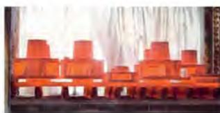
Die **Wärmebehandlungen** werden **im Lohn** im Bereich von 300 – 1.000 °C, insbesondere für größere Glühgüter bis 14,40 m Länge, 4,20 m Breite, 3,00 m Höhe und bis zu **100 t** Einzelgewicht, durchgeführt.
