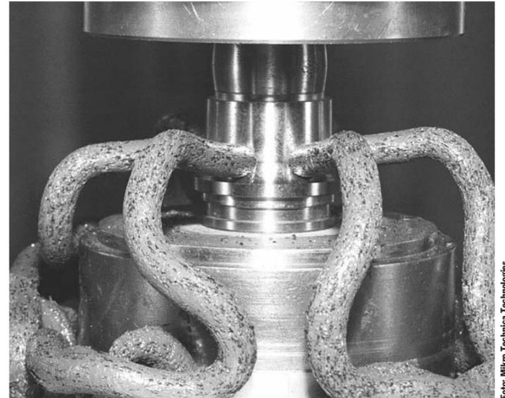
Polymere Kunststoffmasse: das Schleifmedium STREAMER
