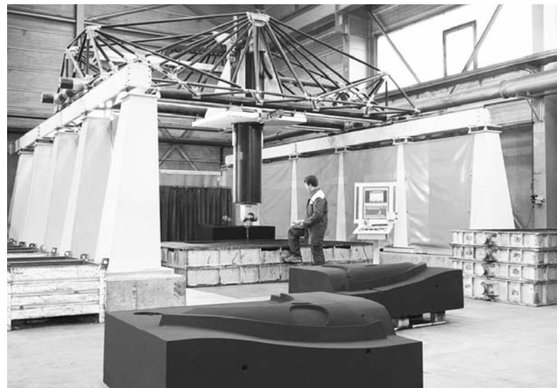
Mit Hilfe der CNC-Großfräse entstehen Sandgussformen für Großteile
