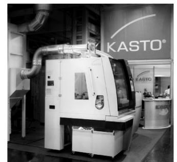
KASTOSpeed M9 mit Absauganlage
