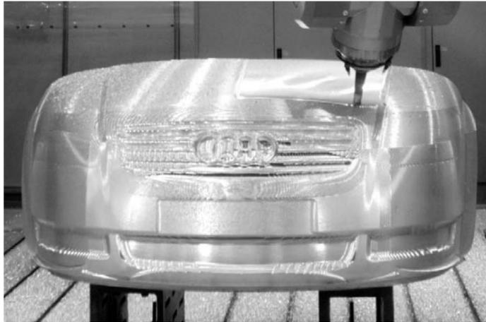
Aluminium erlaubt kurze Bearbeitungszeiten selbst bei großen Teilen
