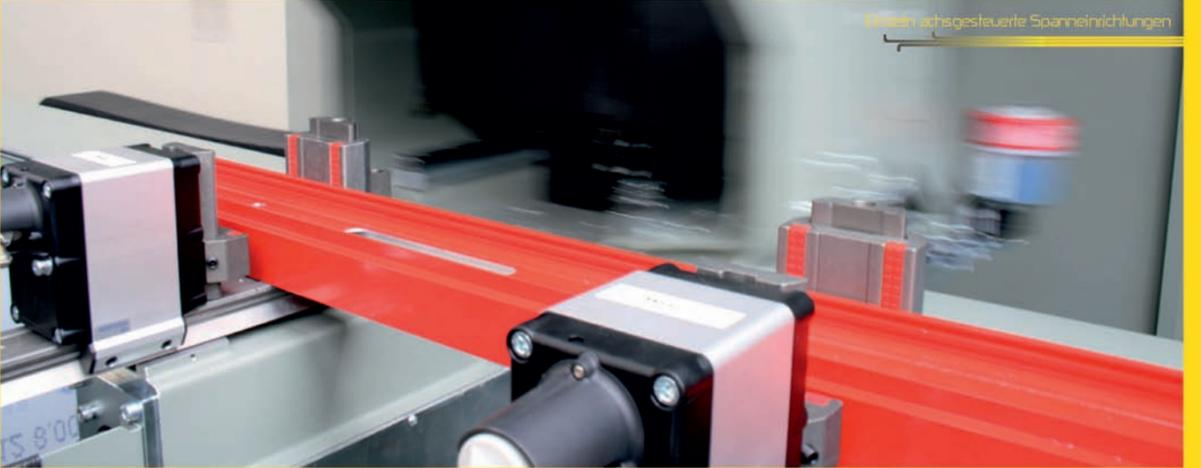
Doppelt achs-gesteuerte Spanneinrichtungen
