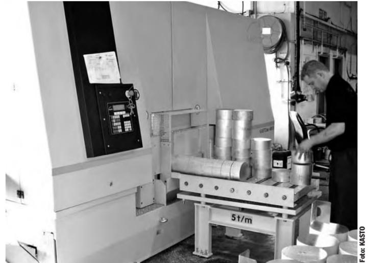
KASTotec AM4 – Hochgeschwindigkeitsbandsäge im Einsatz
