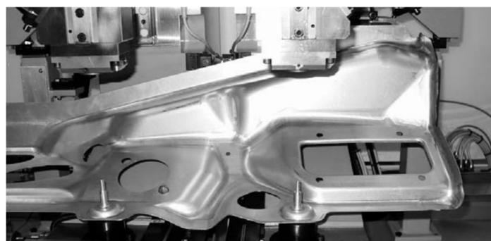
In der Werkstückaufnahme: Stirnwand mit bereits gesetzten Stanzbolzen
