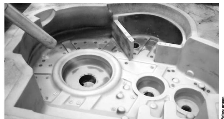
Kernkasten reinigen mit dem IceMaster-Verfahren
