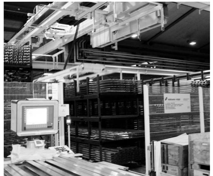
Aluminium Laufen: Transport der Profilkörbe mittels Automatikkrane
