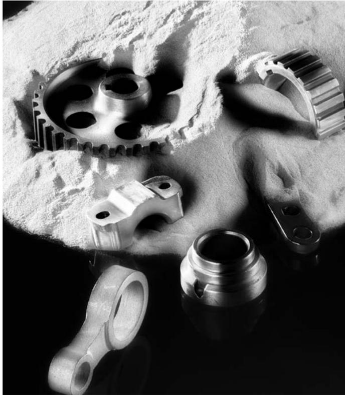
**Alu-Pulver ist Ausgangsstoff für technisch anspruchsvolle Produkte**
